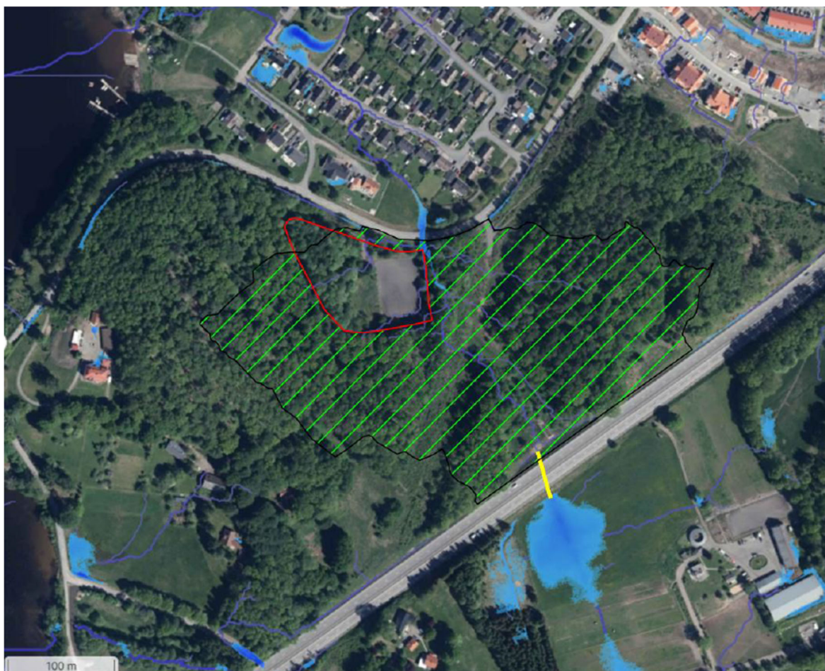
Figur 24. Lågpunkter nedströms och uppströms utredningsområdet (röd linje), kulvertar uppströms (gul linje) samt avrinningsområdet med tillkommande vatten till bäck (grön skraffering).
